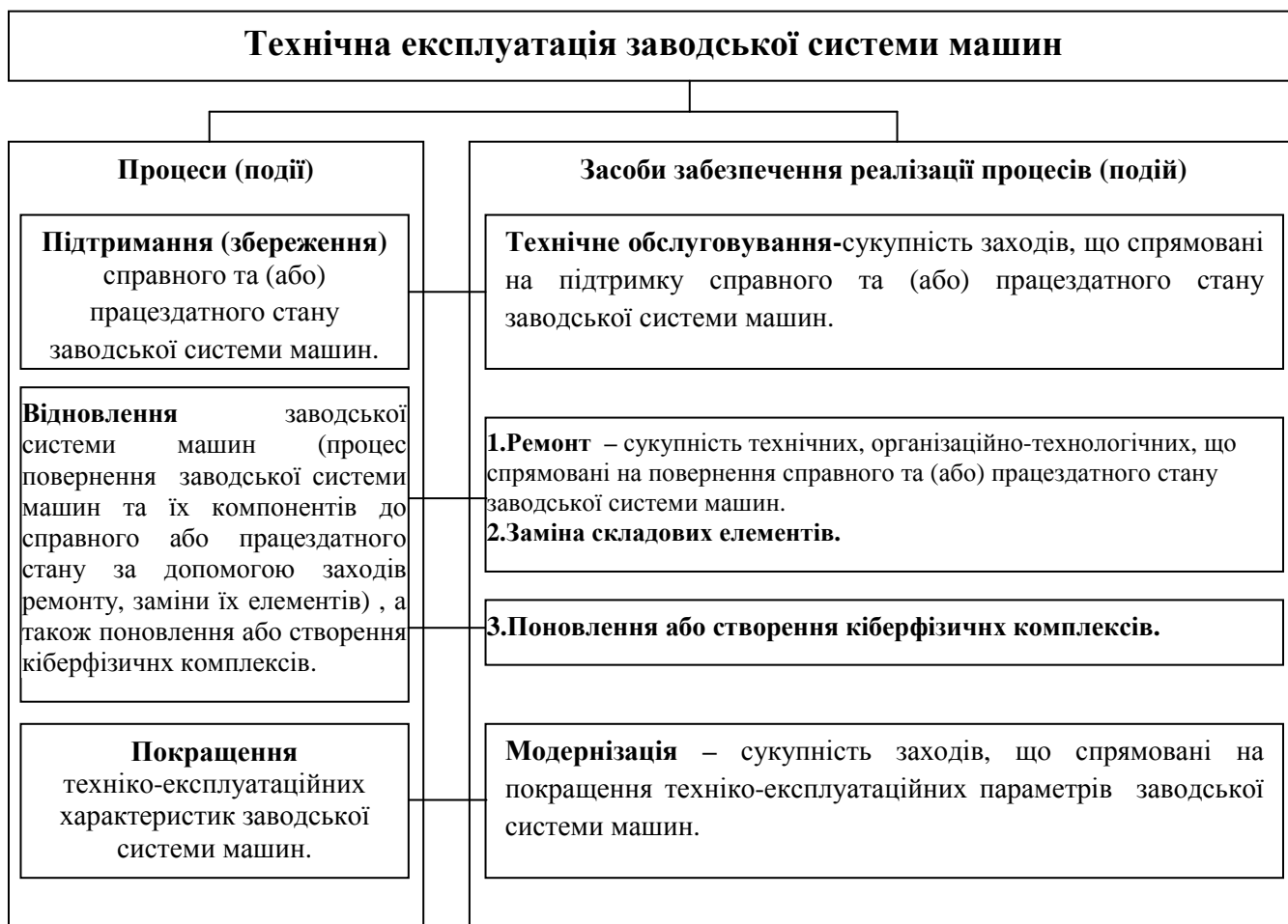
Рис.1. Змістова характеристика та взаємозв'язок основних понять категорійного апарату технічної експлуатації заводської системи машин
